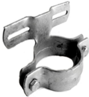
Rohrschelle aus verzinktem Stahl für Flach-VZ, Pfosten \varnothing 42-108 mm, Lochabstand 70-900 mm
